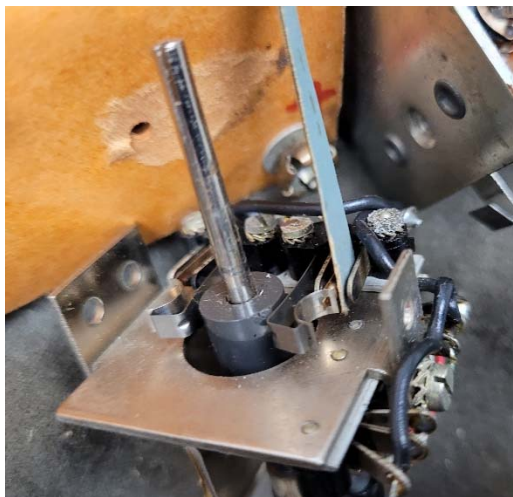
Reinigung der Kontakte mit Hilfswerkzeug (stets umdrehen um beide Seiten zu reinigen)
