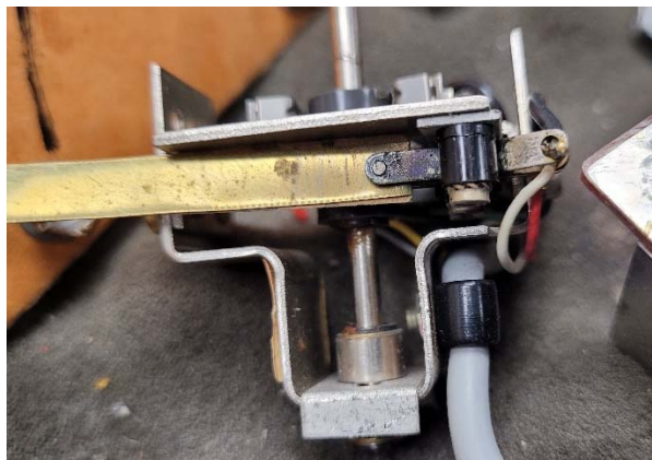
Reinigung der Kontakte mit Hilfswerkzeug (stets umdrehen um beide Seiten zu reinigen)
